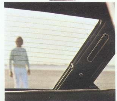
Läpituuletusaukoista vaihtuu ilma jatkuvasti.
