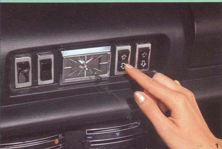
**1 et 2** Au centre de la planche de bord, deux touches commandent l'ouverture et la fermeture de chacune des vitres latérales avant qui s'abaissent totalement.
