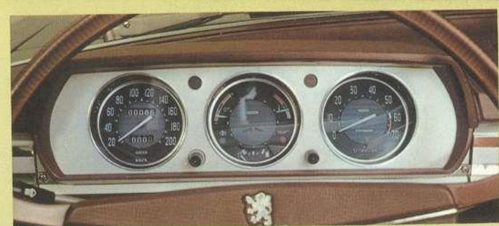
De 504 Sedan met benzine-injectie heeft een elektronische toerenteller
