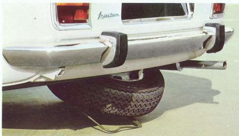
Het onder de vloer opgeborgen reservewiel maakt dat het volume van de bagageruimte geheel benut kan worden.
