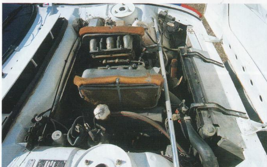
Dans cette version, le V6 à carburateurs développe 240 ch. Avec les rapports longs prévus pour le Kenya, l'auto dépassait 200 km/h.
