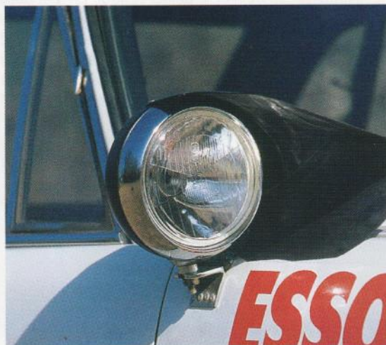
Quelques-uns des équipements spécifiques des rallyes africains de l'époque : phares orientables sur les ailes, poignées de maintien sur le capot arrière et marchepieds sur les pare-chocs pour le cas où le coéquipier devait faire le « singe »...
