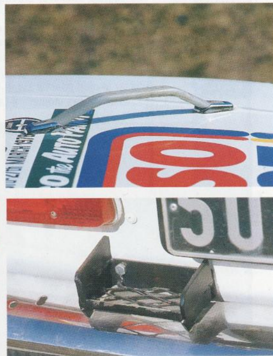
Quelques-uns des équipements spécifiques des rallyes africains de l'époque : phares orientables sur les ailes, poignées de maintien sur le capot arrière et marchepieds sur les pare-chocs pour le cas où le coéquipier devait faire le « singe »...
