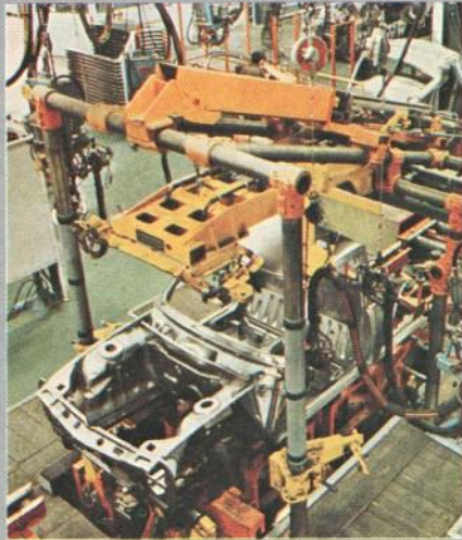
4 1 ère ligne : Soudage du pavillon (3 è berceau) 1st line : Body roof welding (3rd framing fixture) 1. Strasse : Verschweissung des Daches (3. Tragrahmen)
