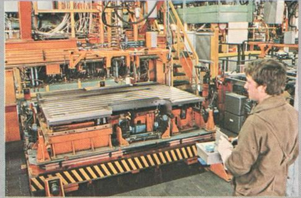
7 Zone plateau arrière : Multipoints tôle + cadre Box floor area : Multiple spotwelding panels on supporting frame Zone Heckplatte : Mehrpunktschweissung Blech + Rahmen
