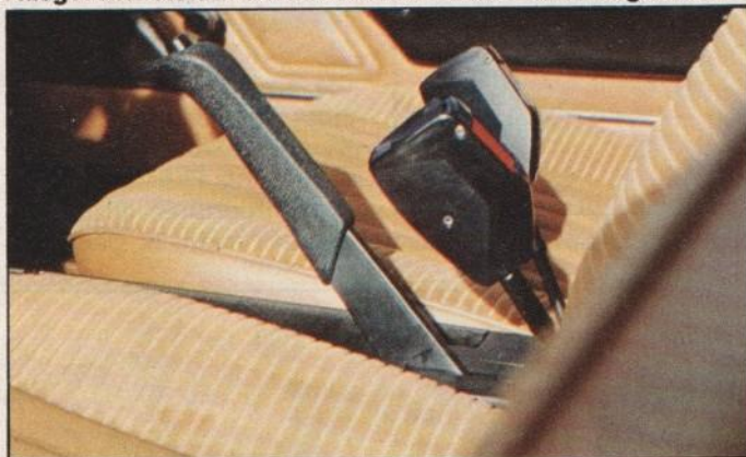
Zu lang: Gurtpeitschen und Hebelweg der Handbremse
