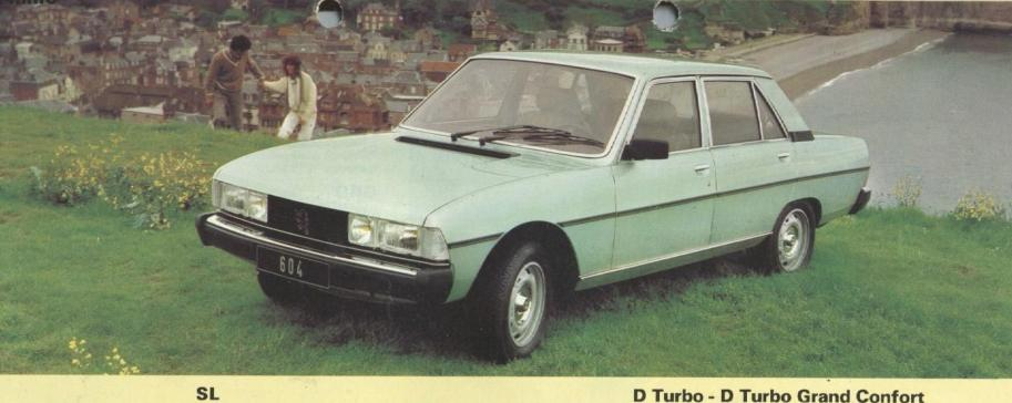
5 places - moteur à carburateurs - 6 cylindres en V - 2.664 cm<sup>3</sup> Puissance administrative : 15 - puissance maxi : 98 KW ISO (136 ch DIN) 4 vitesses - 182 km/h
