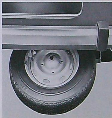
Mettez la roue remplacée dans le panier de roue de secours en orientant la face extérieure vers le haut.
