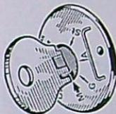
**M** - Clé bloquée dans l'antivol : contact pour fonctionnement du moteur et des appareils protégés par les fusibles 3, 4 et 5.
