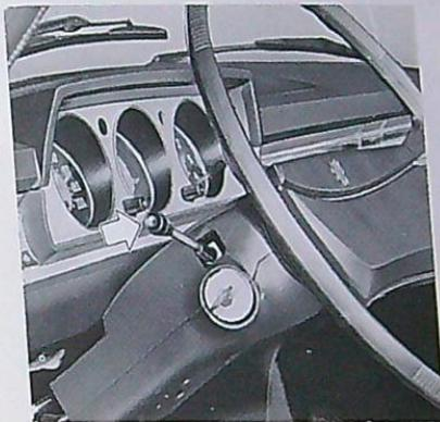
Le fonctionnement permanent de l'essuie-vitre, à deux vitesses différentes, est commandé par l'interrupteur situé à gauche du tableau de bord.
