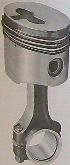
Les pistons en alliage d'aluminium à faible coefficient de dilatation, comportent à la partie supérieure un alvéole en forme de trèfle.
