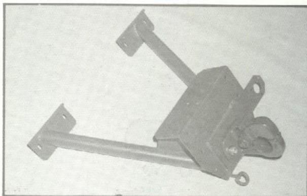
3.534 Attelage AR reculé sous caisse. Permet abaissement complet du hayon. Roue de secours sous plateau condamné.
