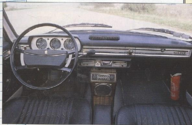
Malgré le bon niveau de leurs performances, les premières 504 Injection ne sont pas équipées de compte-tours.
