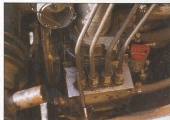
La pompe Kugelfischer in situ. Son réglage est une opération délicate faisant appel à cinq calibres différents.
