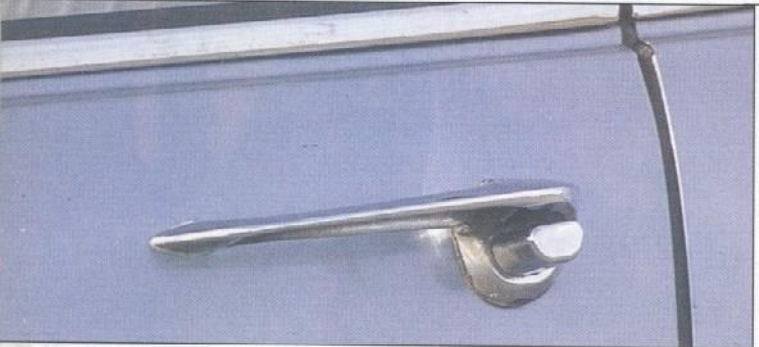
Les poignées saillantes à bouton poussoir intégrés équiperont les 504 jusqu'en 1975. A partir de cette date, elles seront encastrées.
