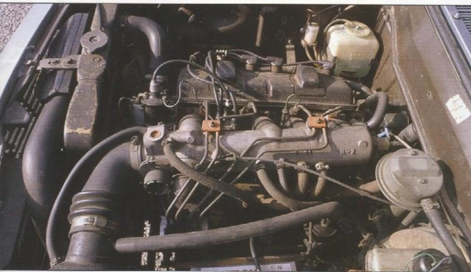
La plupart des opérations d'entretien mécanique sont à la portée d'un amateur sauf le réglage de la pompe d'injection qu'il faut impérativement confier à un spécialiste.
