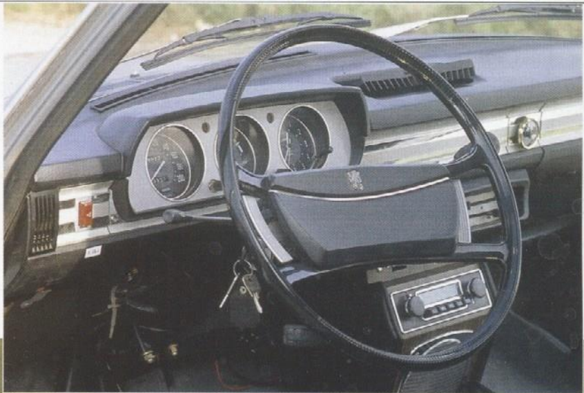
Un tableau de bord sobre et classique, mais une instrumentation succincte puisqu'elle ne comporte même pas de compte-tours.
