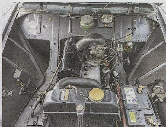
Ruhiger und gemütlicher Geselle: Der 58 PS starke Vierzylinder bietet genügend Drehmoment für gelassenes Fahren
