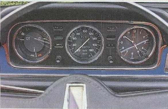
Gut gelöst: Statt eines Kombi-Instruments informieren drei große und gut ablesbare Rundinstrumente den Fahrer
