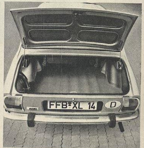
Der Kofferraum des 504 GL ist größer: er faßt 463 Liter. Der Boden ist völlig eben. Noch ein Unterschied: Der GL hat Gummihörner auf den Stoßfängern.
