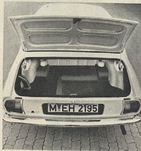
Die starre Hinterachse des 504 L braucht viel Platz. Der Kofferraum faßt nach VDA-Norm nur 408 Liter. Unter dem linken Boden-Buckel sitzt der Benzintank.
