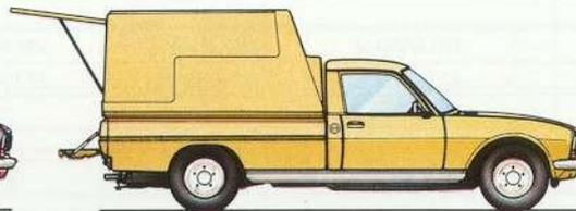
Transporter mit abnehmbarem Hardtop und großer Heckklappe
