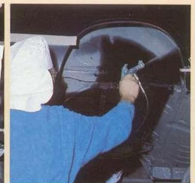
**5. STEINSCHLAGSCHUTZ (PVC):** Mit 140° eingebrannte PVC-Schicht schützt Karosserieteile, die Steinschlag ausgesetzt sind (vor allem am Unterboden und in den Radkästen).
