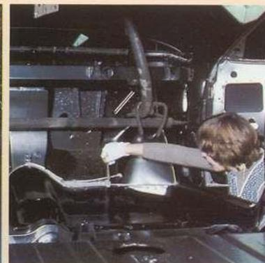
**4. DICHTUNGEN:** An Verbindungen und Verschweißungen zwischen einzelnen Blechen wird Dichtungsmasse aufgetragen, die ein Höchstmaß an Dichtigkeit gewährleistet.
