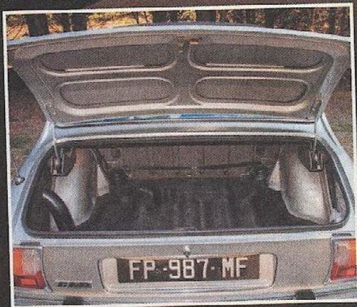
Malgré d'encombrants passages de roues, le coffre est assez logeable. Problème, son accès n'est pas facilité par l'ouverture de la petite malle.
