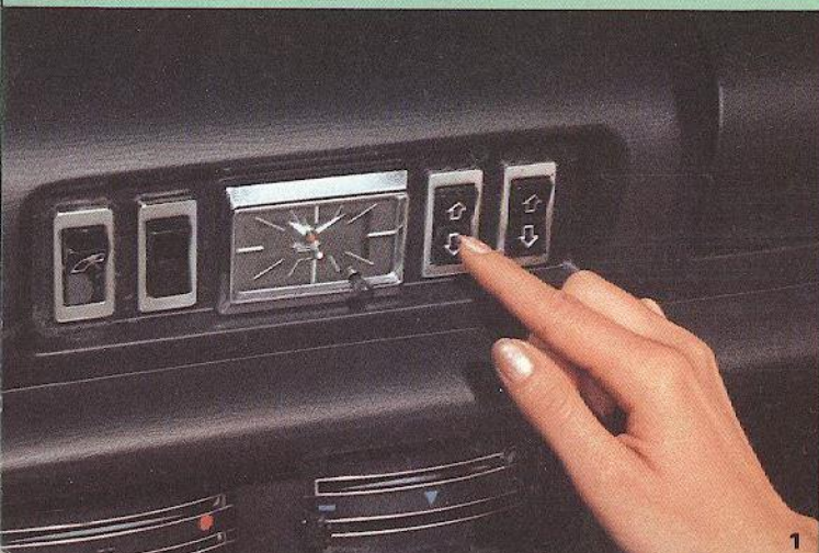
1 & 2 Twee toetsen in het midden van het dashboard zorgen voor het elektrisch openen en sluiten van de beide portierramen. De scheerraampjes met vergrendeling completeren de uitvoering van de portieren.
