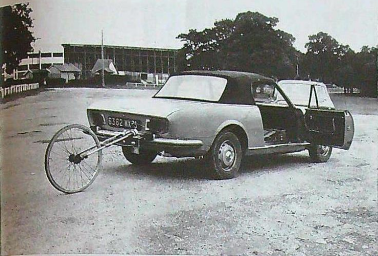
Afin de pouvoir établir nos courbes d'accélération et obtenir la distance de freinage, nous utilisons cette « 5 e roue » qui transmet les indications nécessaires.
