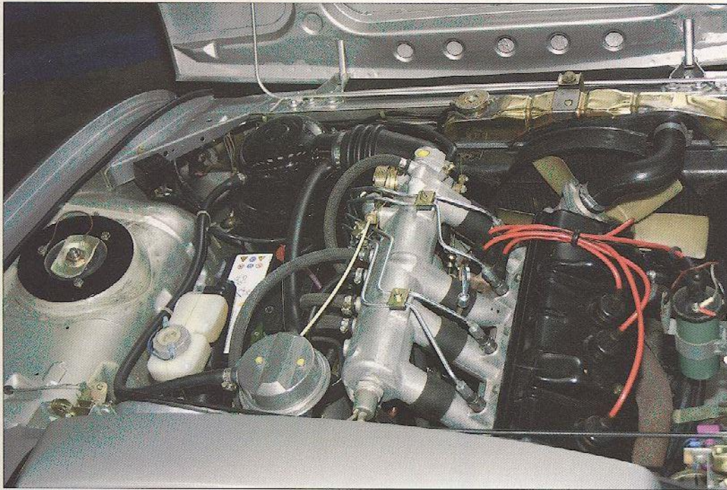
Réputé fiable, le 2 litres 4 cylindres a traversé les époques sans beaucoup de modifications. Ses performances permettaient une vitesse de pointe de 180 km/h.
