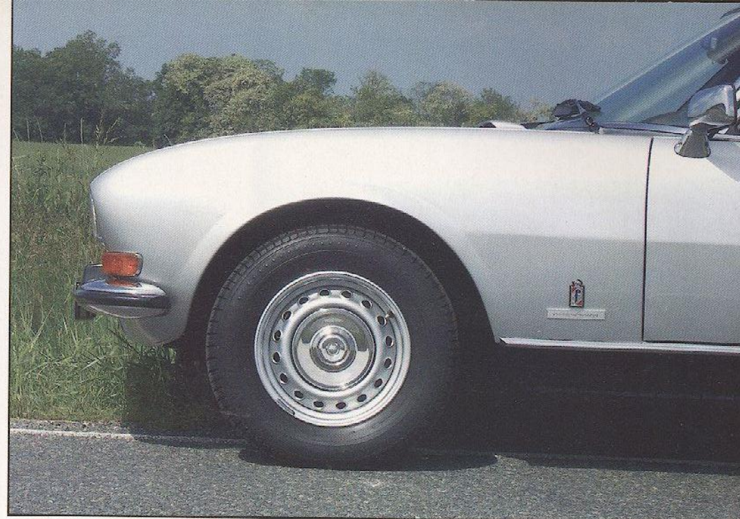
Cette version 1979 a conservé ses belles jantes 16 trous en tôle, repeintes et chaussées de Michelin Energy.
