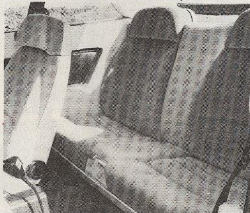
Le siège de la Lancia s'avance automatiquement pour accéder aux places arrière
