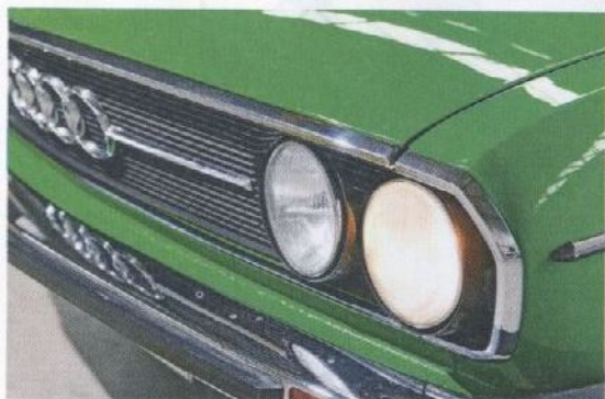
FACELIFT Bügelalte im Kotflügel, Kunststoff- grill und geänderte Stoßstangen ab August 73
