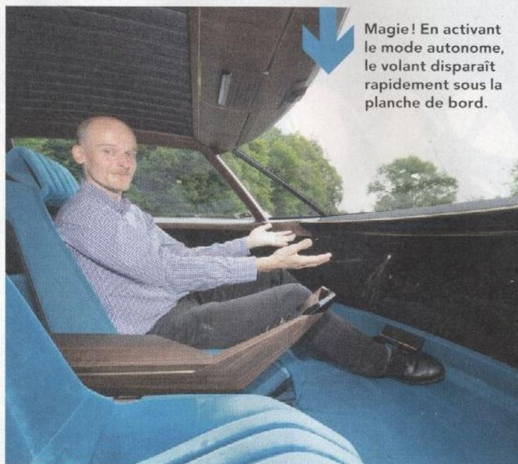
Magie ! En activant le mode autonome, le volant disparaît rapidement sous la planche de bord.
