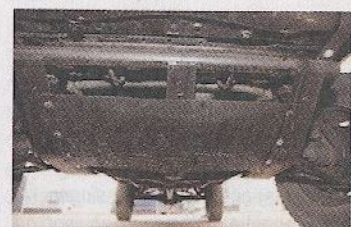
Met de optionele carterbeschermplaat kan de 504 Dangel de ergste obstakels zonder problemen te lijf gaan.
