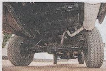
De stationcar heeft een schroefgeveerde starre achteras, bij de pick-up-variant is de as zelfs nog bladgeveerd.
