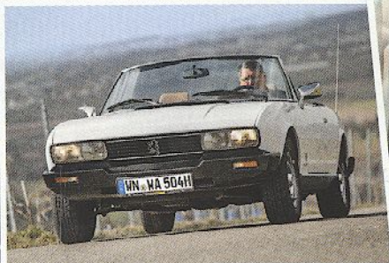
Stoßstangen aus schwarzem Kunststoff ersetzen 1979 die Chrom-Vorgänger
