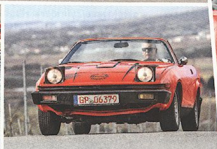
Durch Klappscheinwerfer erzielte Triumph die in den USA vorgegebene Einbauhöhe
