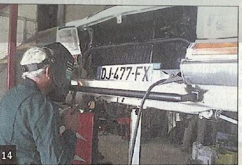
14 Jean-Pierre, un ami, confectionne la barre de support des longue-portée, en copiant celle de l'authentique 504 Bandama du musée Peugeot.
