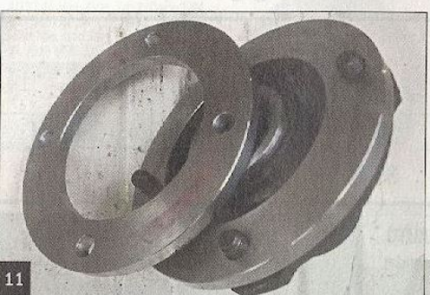
11 Christian opte pour une monte de pneumatiques plus grands et doit faire fabriquer des élargisseurs de voies pour faire passer les nouveaux pneus.
