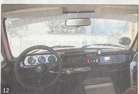
12 Le tableau de bord est refait et, surtout, modifié pour recevoir les commandes des longue-portée et le Terra-Trip. Le système électrique a été revu en conséquence.
