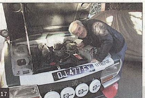
17 La capsule à dépression de l'allumeur était défectueuse. C'est Gaston qui découvre la panne et en profite pour régler l'avance à l'allumage.
