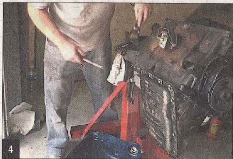
4 Séance nettoyage du bloc, à la spatule et à l'essence pour enlever la crasse. Chemises et pistons sont en bon état et sont conservés.
