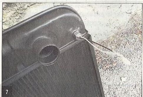
7 Le radiateur, refait chez Provence radiateurs, est modifié pour recevoir une sonde adaptée au montage d'un thermomètre précis.
