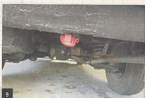
9 Le montage de crochets de remorquages adaptés, et peints en rouge, est rendu obligatoire par le règlement de l'épreuve. Une sécurité !
