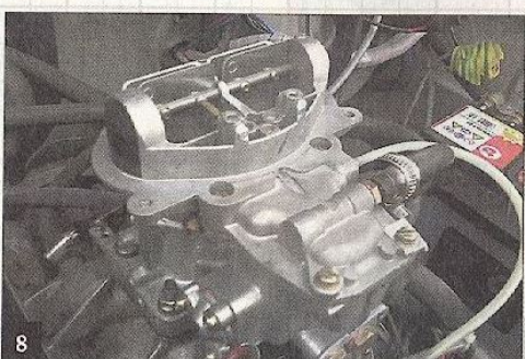
8 Pour améliorer un peu le rendement du 4-cylindres Peugeot, Christian change le carburateur pour un modèle avec une pompe de reprise.
