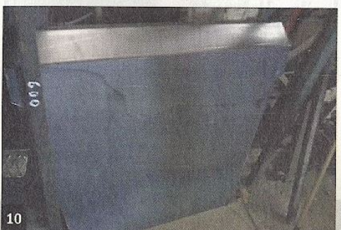
10 Un ski de protection en tôle de 3 mm est réalisé pour éviter que les pierres des pistes marocaines n'endommagent le carter d'huile.
