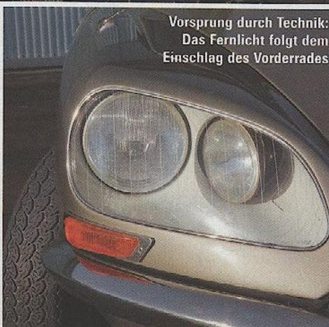
Vorsprung durch Technik: Das Fernlicht folgt dem Einschlag des Vorderrades
