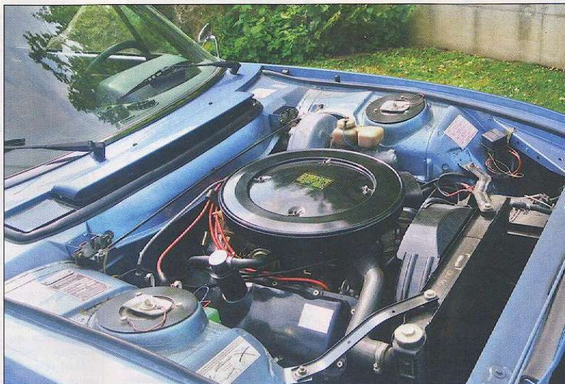
Le moteur V6 PRV et son imposante «gamelle» de filtre à air ! Celui-ci totalise à peine 40 000 km d'origine. Il a toujours été très bien entretenu, d'où son état irréprochable.
