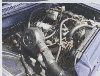
Archaischer Volvo-Motor mit Stirnradantrieb und nur einem Vergaser. Immerhin hat der B20 schon fünf Kurbelwellenlager. Alles im Kasten, Drehzahlmesser erst ab 144 Grand Luxe
