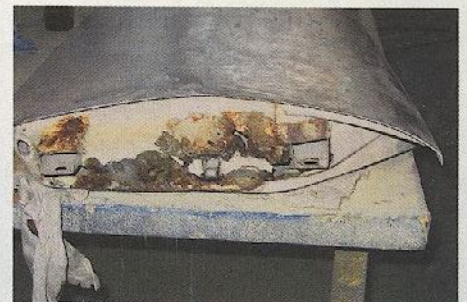
Noch nie gesehen: Die senkrechte vordere Wand des Türkastens war völlig morsch
