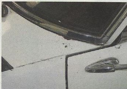
Da gammeln sie doch alle: Am unteren Teil des Scheibenrahmens herrschte Handlungsbedarf
