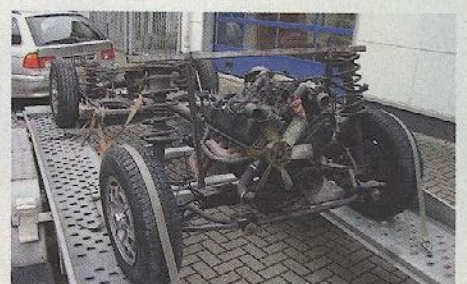
...der Fahrschemel nach oben abheben. Antrieb und Achsen bleiben auf dem Boden der Tatsachen
