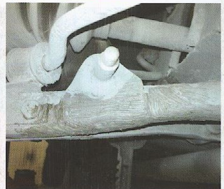
De schokdemper weer keurig gelast.
