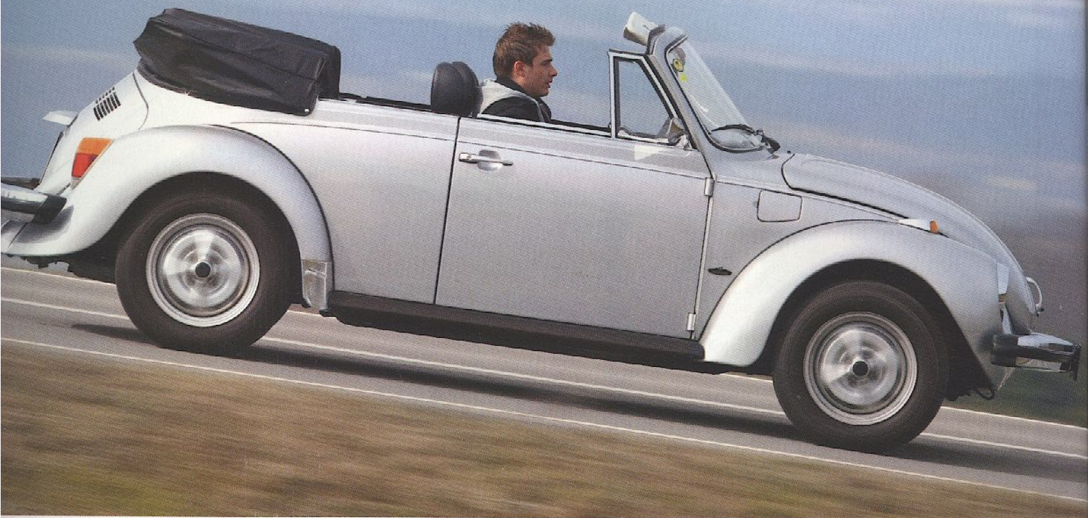
Der 1303 mit der gewölbten Frontscheibe löste 1972 den glücklosen 1302 ab. Aber selbst in seiner letzten Ausbaustufe ist der Käfer ein Käfer geblieben
