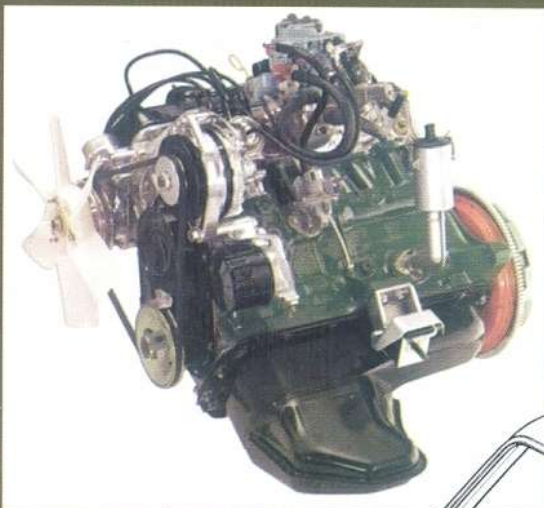
Motor van de GL sedan uit 1974, een viercilinder van 1.971 cc en vijfmaal gelagerde krukas.
