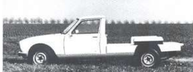
Bedrijfsautoversies hadden een starre achteras, zoals deze cabine/chassis voor speciale opbouwen.
