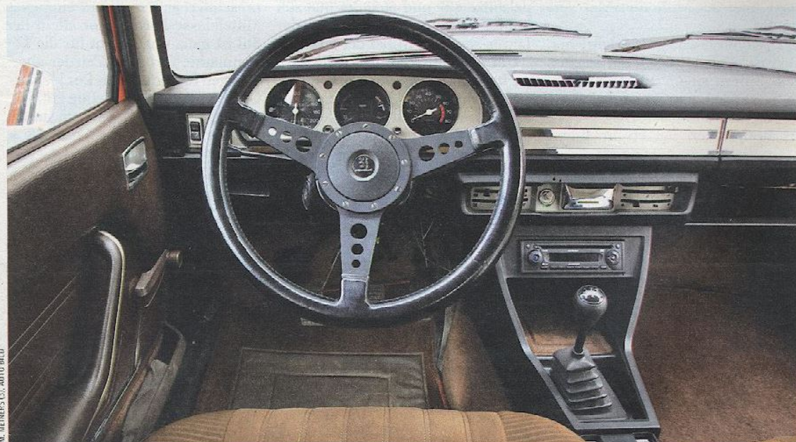
Chrom und Leder gab es auch 1978 schon - unser 504 GL hat ein Moto-Lita-Lenkrad und ein nachgerüstetes Fünfganggetriebe
