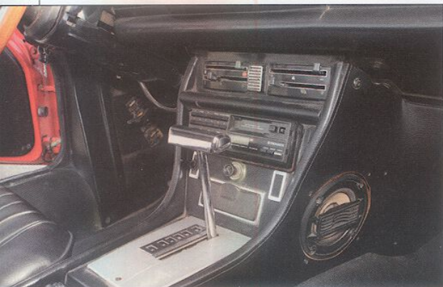
Le levier de vitesse est placé sur une console centrale permettant l'installation d'un autoradio et d'un cendrier avec allume-cigare.
