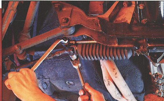
Verschleiß an den Spurstangen . Oft sind nur die äußeren Spurstangenköpfe ausgeschlagen, andernfalls greift man zu einem Reparatursatz
