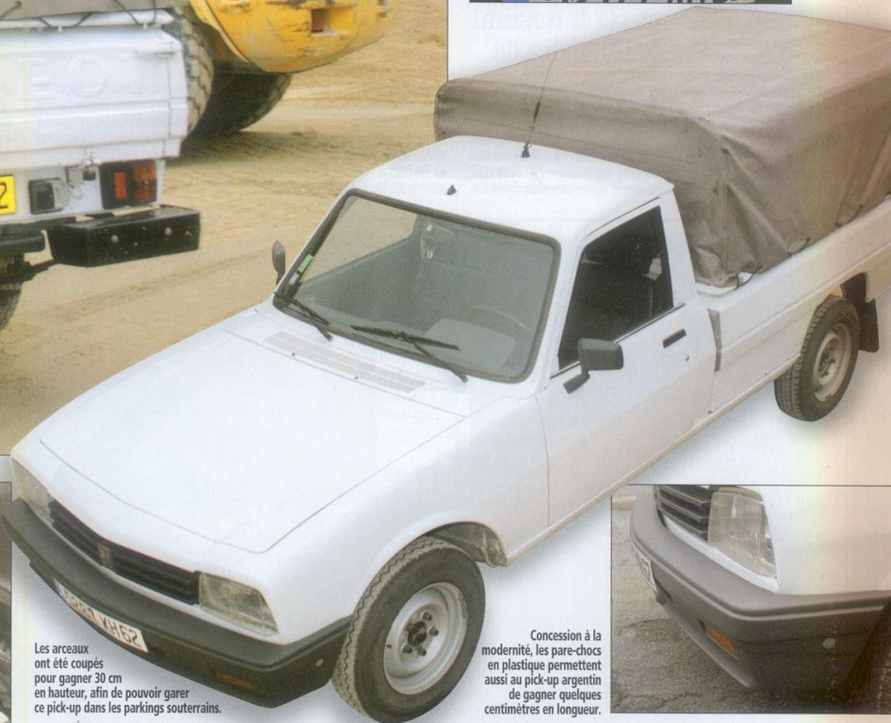
Concession à la modernité, les pare-chocs en plastique permettent aussi au pick-up argentin de gagner quelques centimètres en longueur.
