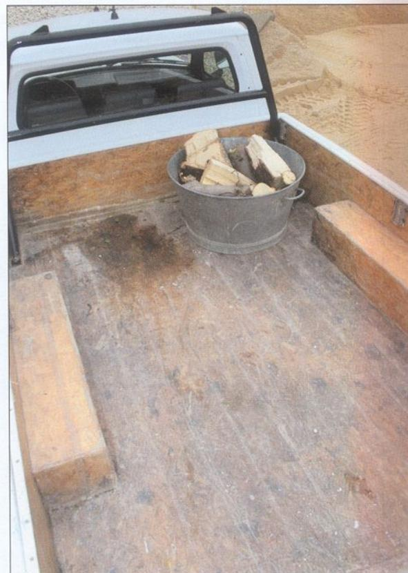
Avec une surface utile au sol de plus de 3 m<sup>2</sup>, la benne du pick-up 504 est vraiment gigantesque. L'arceau « porte-échelle », monté en série sur la version argentine, était disponible en option seulement sur les derniers millésimes des françaises.
