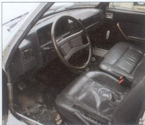
Le pick-up argentin a abandonné le tableau de bord traditionnel de la 504 connu depuis 1979, pour ce modèle propre à la gamme des berlines argentines.
