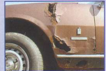
Durchbrüche an der Schottwand führen zu „Schwarzen Löchern“
