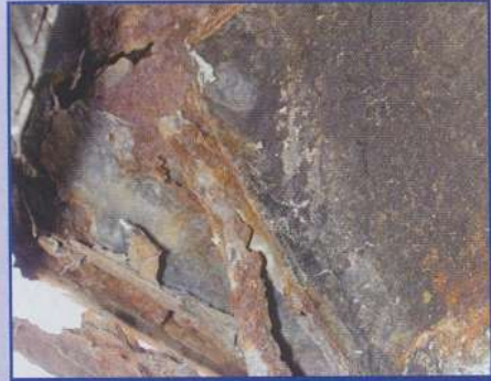
...alle Bleche selbst anfertigen – in Bereichen wie hier unter der A-Säule ein schwieriger Job
