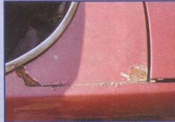
Cabrio-Standard: Rost zwischen Verdeckkasten und Seitenteil
