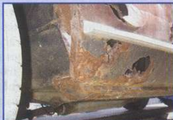
Löchrige Radhaus-Schottwände ziehen löchrige A-Säulen nach sich
