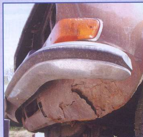
Hier geht's los: Rost an der Frontschürze gehört zum Standardprogramm beim 504
