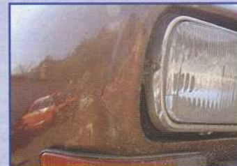
Zwischen Kotflügel und Maske sorgen (Un-)Dichtungen für Blasen
