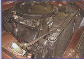
V6: in der Regel bis 300.000 km ohne Befund, Vergaser sind rar
