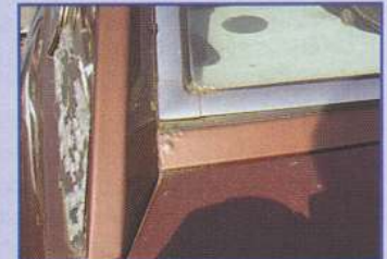
Pusteln an den Scheibenrahmen verheißern weitere Arbeit
