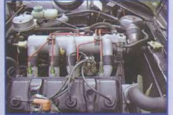
Vierzylinder: langlebig, vereinzelt Probleme mit der Einspritzanlage
