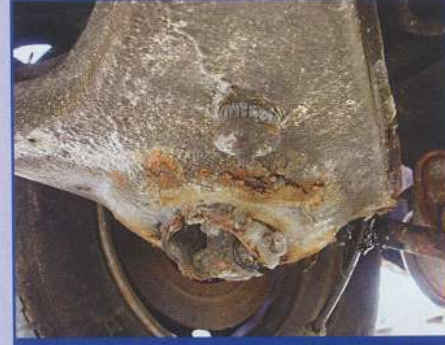
Die hinteren Längslenker sind fertig? Dann wird's mit 650 Euro pro Seite richtig teuer
