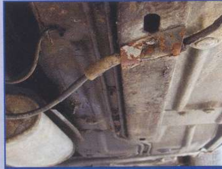
Längsträger: über die ganze Länge gefährdet, die Vorderachsaufnahme ist besonders kritisch
