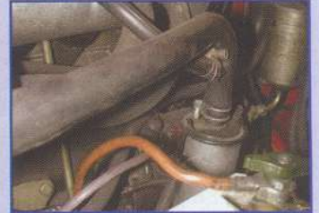
Brandstifter: Der Benzinschlauch scheuert am Anlasser
