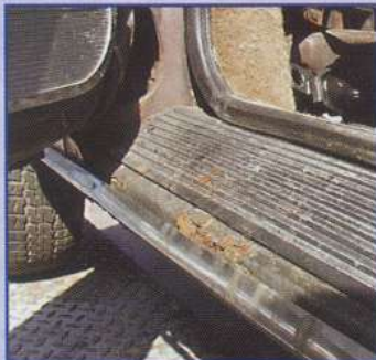
Verdecktes Elend: Blätterteig unter den Einstiegsblenden
