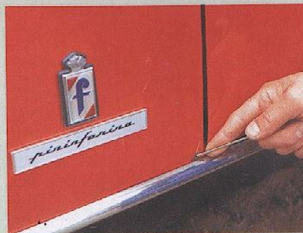
Mürbe: Auch an den A-Säulen gammelt's, mit Kosmetik sind jedoch zwei Jahre Spaß drin
