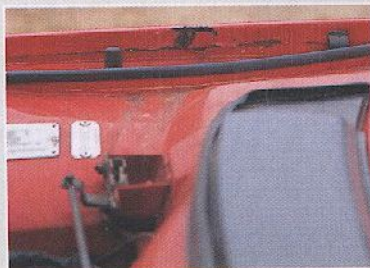
Rost verleiht Flügel – Kotflügel. Langer Alltagseinsatz fordert seinen Tribut
