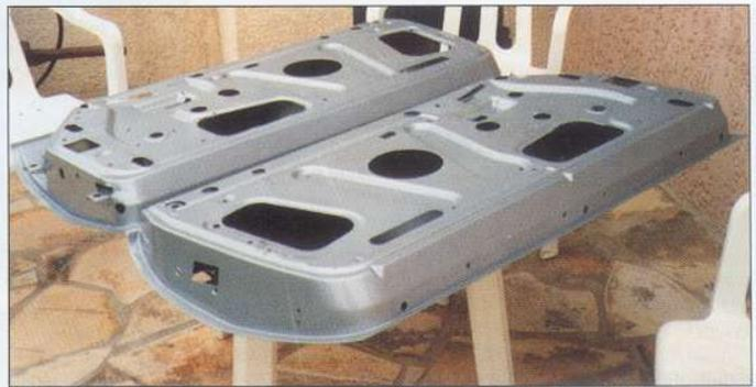
« Restauration de l'intérieur des portes : décapage, traitements anticorrosion avant une couche de peinture. »
