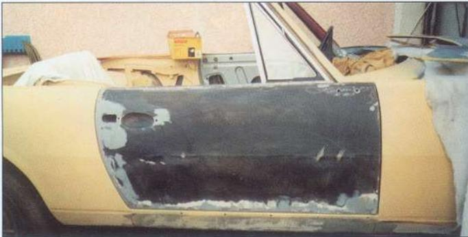
« J'installe les portières pour régler l'alignement. Je fais la même opération avec le coffre et le capot. »
