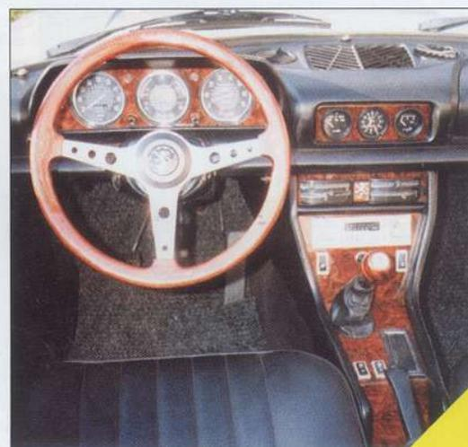
« Pourquoi ne pas se faire plaisir en personnalisant son intérieur ? Les boutons des vitres électriques sont ainsi déplacés sur la console centrale. Au centre de la planche de bord, ils sont remplacés par un thermomètre de température d'eau, une nouvelle montre et un manomètre de pression d'huile. On peut également remarquer, sur le pare-brise, l'installation des pressions pour le couvre-tonneau. »
