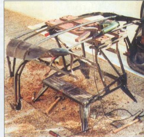
« Les arceaux de capote sont démontés pour être repeints. Le premier, celui qui est près du pare-brise, ici démonté, était tellement malade qu'il a fallu le refaire presque entièrement. Le tissu sur le côté sera également remplacé. »
