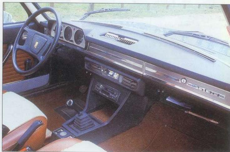
Le tableau de bord ne choquerait pas un possesseur de 404 : les trois cadrans sont toujours là, mais le volant est nouveau et le moyeu « capitonné ». Le levier de vitesses au plancher est une option.
