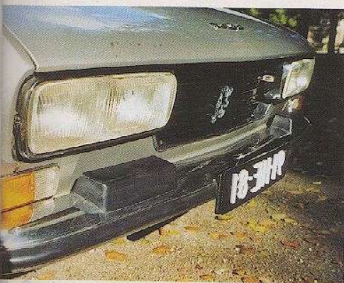
De allereerste modellen van de Coupé en Cabriolet hadden gescheiden dubbele koplampen. Vanaf 1975 zijn die lampen samengevoegd in één grote unit, die minder roestgevoelig is.
