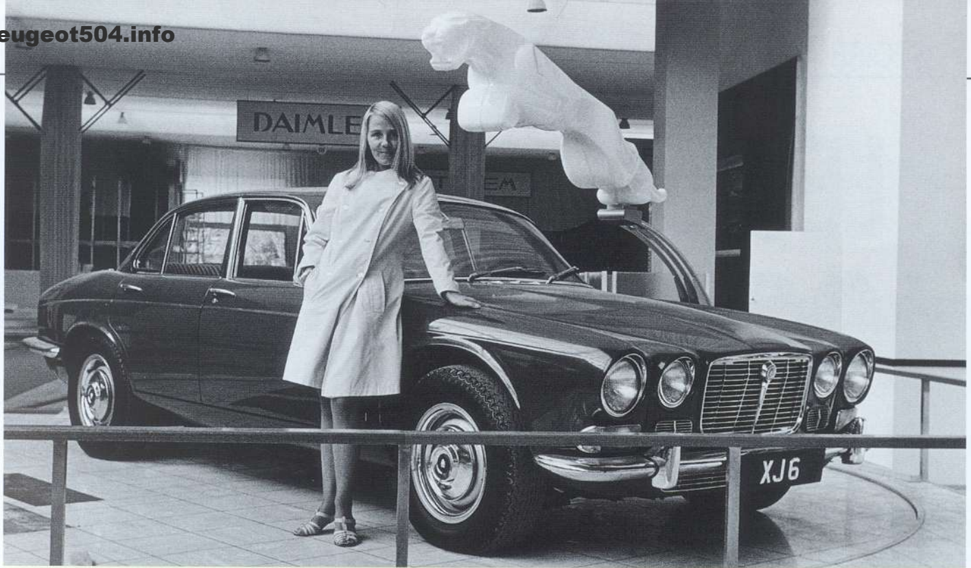
La finition de cette Jaguar XJ6 de 4,2 l de cylindrée faisait l'admiration des visiteurs du Salon. 186 ch à 4500 tr/mn, 2 arbres à cames en tête, elle faisait le km départ arrêté en 32", plus lente d'une demi-seconde que la 504 6-cylindres (24" pour une Ferrari Daytona), mais coûtait 44 720 F.
