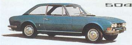
COUPÉ 4 PLACES Moteur à injection 11 CV / 1700 cc S&L - 178 km/h Suspension à 4 roues indépendantes - Pneu à disque sur les 4 roues Assistance de direction
