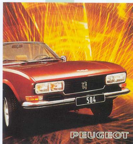
COUPÉ 4 PLACES Moteur à injection 11 CV / 1700 cc S&L - 178 km/h Suspension à 4 roues indépendantes - Pneu à disque sur les 4 roues Assistance de direction
