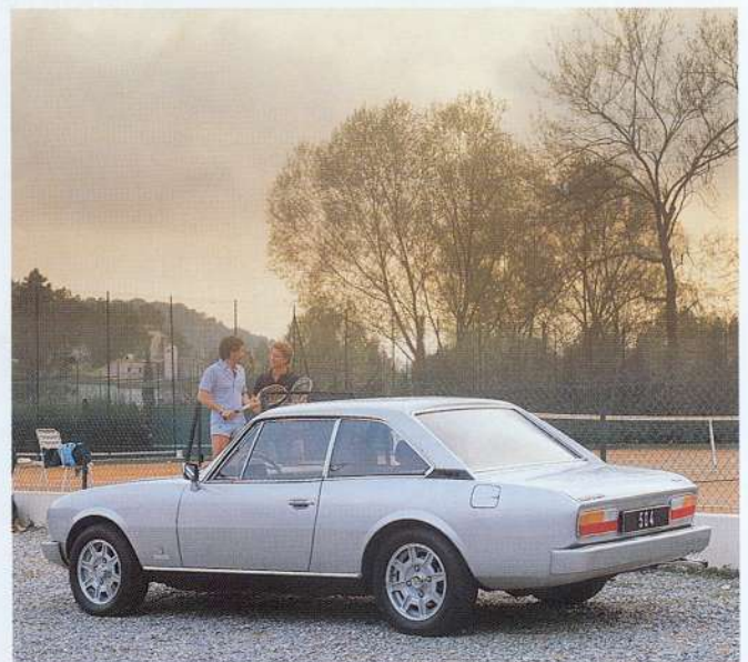
Le coupé du millésime 1981 avec ses roues en alliage léger montées de série avec le 6-cylindres Ti. On aperçoit le monogramme rappelant le moteur sur le coffre de malle. On voit également que la trappe d'embouchure de réservoir a été rehaussée.
