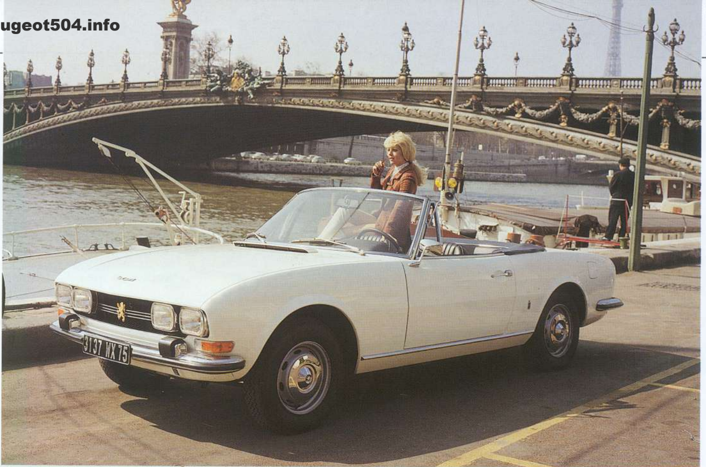
Le cabriolet de la période 4 cylindres de 1970 à 1974. Les feux de positions ont disparu des ailes avant. On remarque le couvre-capote, réputé difficile à installer et on devine les sièges en Teplaine, une sorte de Skai. Le tapis de sol des cabriolets était en caoutchouc, celui des coupés en moquette.
