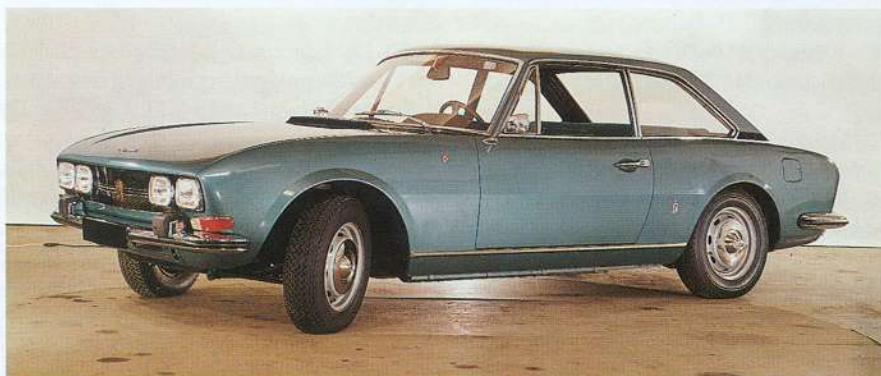
La toute première version du Coupé tel qu'il fut présenté au Salon de Genève 1969. On remarque le feu de position sur l'aile avant, la grille d'aération en plastique noir devant le pare-brise, la calandre barrée par 3 tiges chromées, et les pare-chocs en inox avec des butoirs carrés..
