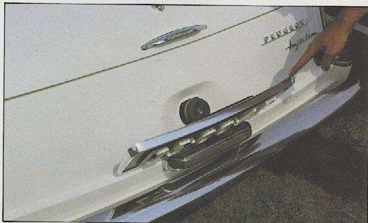
Een onbekende kan lang zoeken naar de benzinevuldop van de 404 Cabrio. Die zit dus achterop, verborgen achter de nummerplaat.
