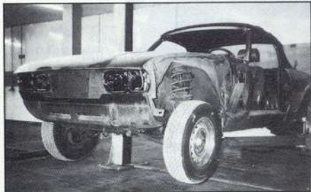
Das ganze Ausmaß des Rostfraßes wird meist erst nach der Abnahme der vorderen Kotflügel deutlich.
