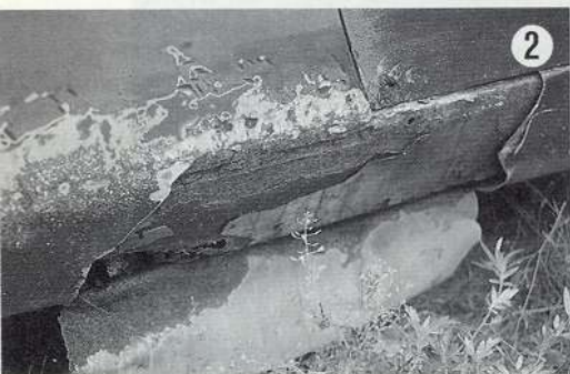
Korrosion im Schwellenbereich läßt sich oft erst durch das Auftrennen des Schwellenblechs erkennen.
