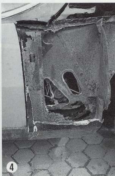
Entscheidender Korrosionsschwachpunkt ist die A-Säule, die hier rettungslos verrostet ist.
