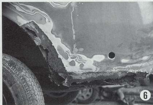
Pfusch-Arbeit: Unter der optisch guten Seitenwand wuchert hier der Rost.
