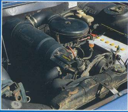
Die Vergaser-Version des Zweiliter-Vierzylinders im Peugeot 504 GL leistete ursprünglich 93 PS
