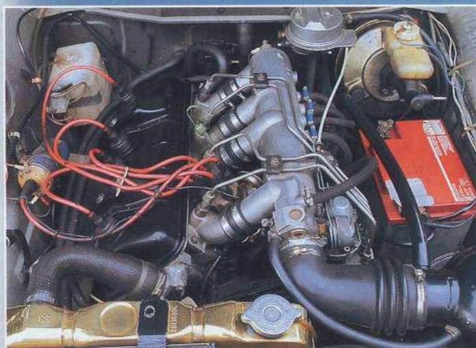
Robuster Geselle: Der Zweiliter-Vierzylinder gilt als ausgesprochen zuverlässig und langlebig. Ab 1976 leistete er 106 PS
