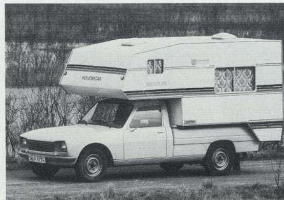
Mit einem abnehmbaren Wohnmobil-Aufbau wird der 504 je nach Bedarf zum Reise-Auto oder zum Pritschenwagen für die gewerbliche Nutzung.
