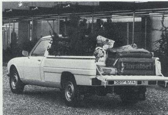
Die Pritsche kann mit einem flachen Ladeboden aus Holz ausgelegt werden, Heck- und Seitenwände werden mit wenigen Handgriffen abgeklappt.
