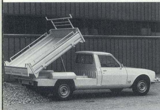
Kipper mit hydraulischem Hubzylinder und elektrischer Druckpumpe oder manueller Betätigung, auch als Dreiseiten-Kipper lieferbar.
