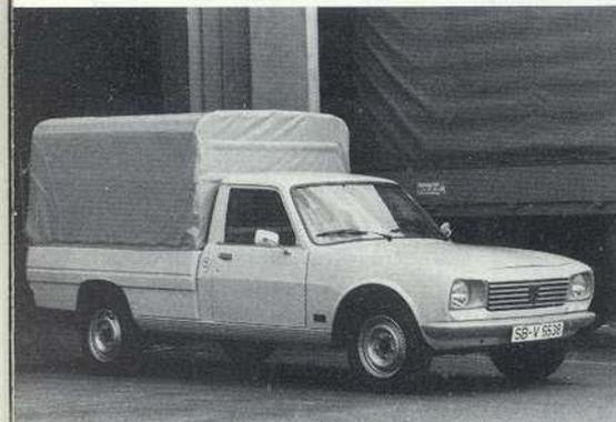
Pritschenwagen mit abnehmbarer Plane, Nutzfläche der Pritsche ca. 4,2 m<sup>2</sup> – in dieser Version in Frankreich ein beliebtes Lastauto.
