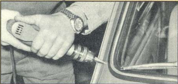
Antennenfräser im Einsatz
