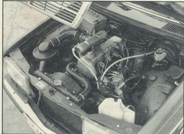
65 PS-Diesel-Vierzylindermotor des Mercedes 240 D
