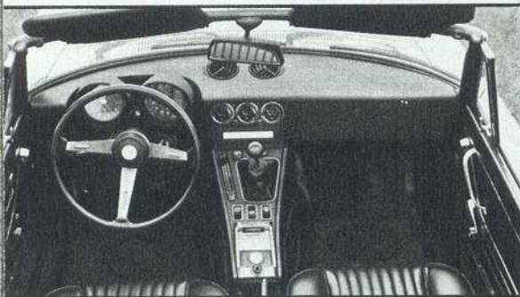
*Cockpit in bewährter Alfa-Manier: spiegelfreie, große Instrumente. Lenkrad mit nicht rutschfestem Holzimitatkranz.*
