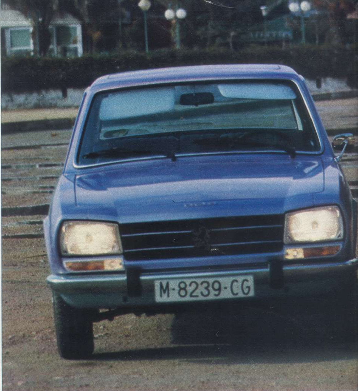
Excelente el rendimiento luminoso de los amplios faros, dotados de lámpara halógena H-4.
