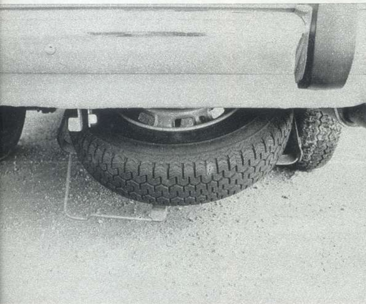
La rueda de repuesto se sitúa bajo el maletero; para soltarla basta con actuar en un tirador que hay en el piso.
